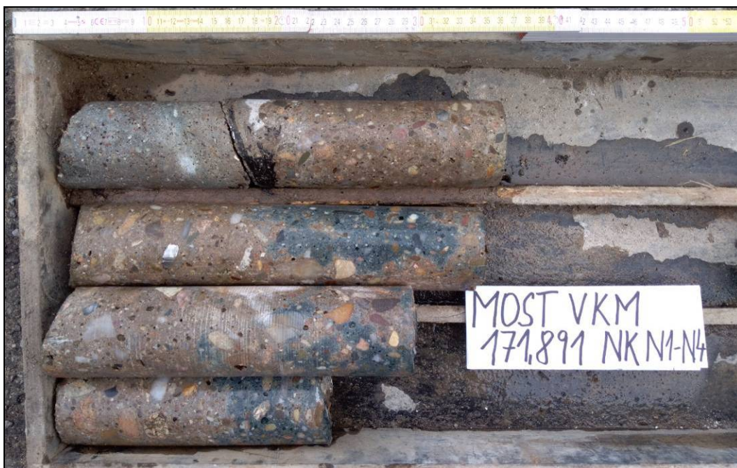
Obr. č. 1 - diagnostické návrty N1 – N4 do čela pravé části nosné konstrukce
