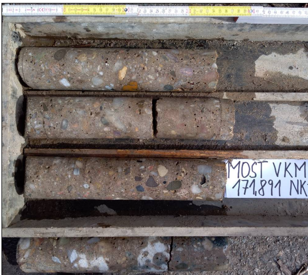
Obr. č. 2 - diagnostické návrty N5 – N8 do čela levé části nosné konstrukce
